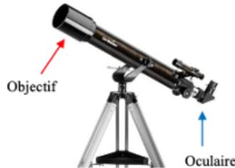
La lunette est un système optique afocal c'est-à-dire que si l'objet est à l'infini alors l'image observée l'est également. Dans ce cas, le foyer image de l'objectif est confondu avec le foyer objet de l'oculaire.
