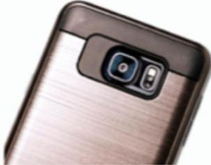
L'objectif est modélisé par une lentille mince convergente liquide et fixe.
