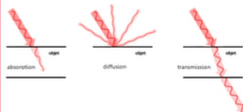
**Remarque :** La plupart des objets opaques diffusent une partie de la lumière reçue et absorbent le reste.
