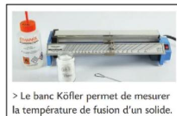
> Le banc Köfler permet de mesurer la température de fusion d'un solide.
