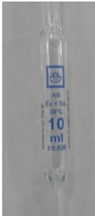
a) Quelles sont les sources d'erreurs lors de l'utilisation d'une pipette jaugée ? Quelles informations sur la pipette jaugée permettent d'en quantifier deux ?
