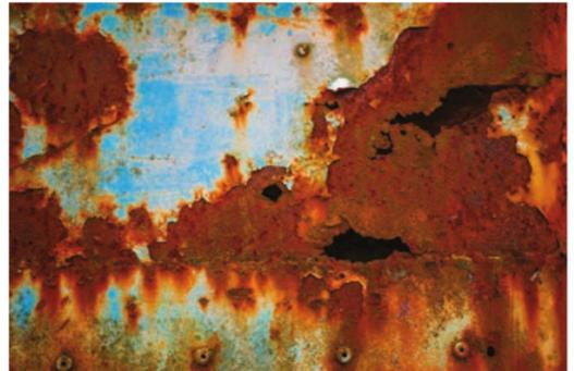
Tôle de fer percée par la corrosion ▶
