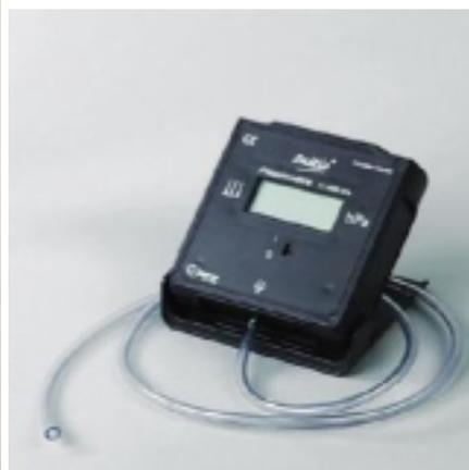
Le manoscope permet de mettre en évidence la pression exercée par un liquide. Il est constitué d'une capsule manométrique munie d'une membrane élastique. Toute poussée sur cette membrane comprime l'air emprisonné dans la capsule dont l'augmentation de pression est transmise à un manomètre numérique. La capsule manométrique est mobile horizontalement et verticalement et est libre en rotation autour d'un axe horizontal passant par le centre de la membrane élastique.
