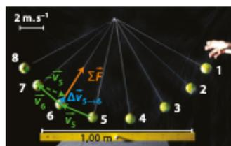
3. Pour construire le vecteur variation de vitesse  $(\Delta \vec{v})_{5 \rightarrow 6}$ , on reporte à l'extrémité du vecteur  $\vec{v}_6$  le vecteur  $-\vec{v}_5$ . Le vecteur  $(\Delta \vec{v})_{5 \rightarrow 6}$  a pour origine l'origine de  $\vec{v}_6$  et pour extrémité celle de  $-\vec{v}_5$ .
