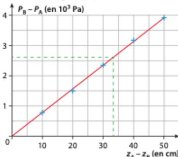
Pour  $P_B - P_A = 2,7 \times 10^3 \text{ Pa}$ , la différence de coordonnées verticales est  $z_A - z_B = 35 \text{ cm}$ .
