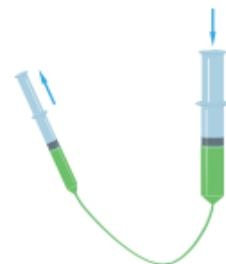
**Remarque :** si l'une des deux seringues possède un piston de plus faible diamètre, la force à exercer sera plus faible pour faire monter le piston de l'autre seringue.
