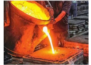
Métal en fusion dans une fonderie
