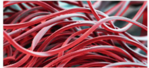
> Fibres de polyester vues au microscope électronique.
