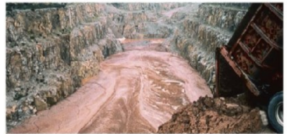
➤ Stockage de déchets de traitement de minerai (résidus) dans l'ancienne mine à ciel ouvert de Bellezane
