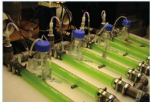
Fig. 10.9 Photobioréacteur expérimental conçu au Laboratoire de biochimie végétale pour évaluer les capacités de production d'hydrogène de micro-algues *Chlamydomonas*.
